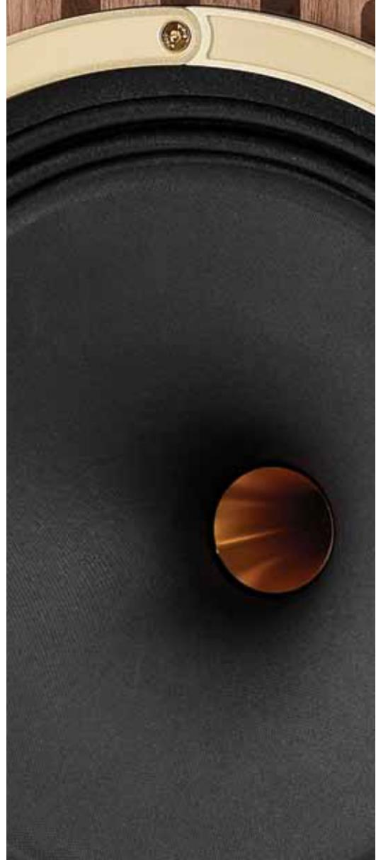
Частотная характеристика рупорной головки расширяет частотный диапазон кроссовера более чем на две полные октавы вниз для устранения окрашиваний, которые могут возникать при воспроизведении звука выше основной резонансной области.
